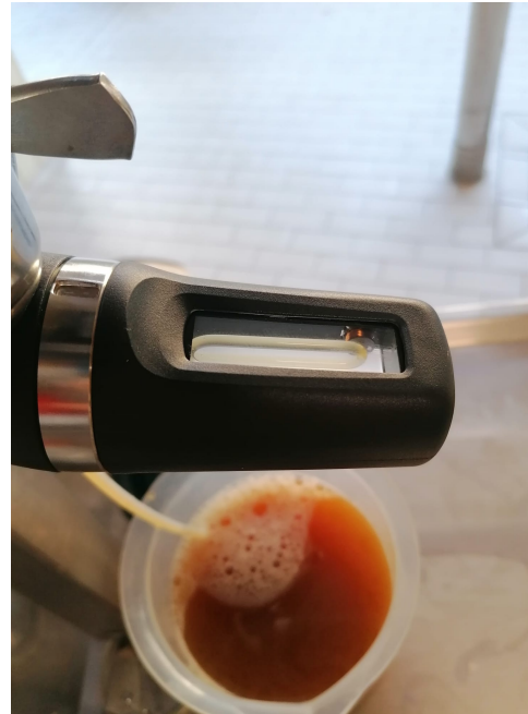
Figura 9 e 10. Anton Paar per rilevazione in tempo reale di estratto, temperatura e densità.
