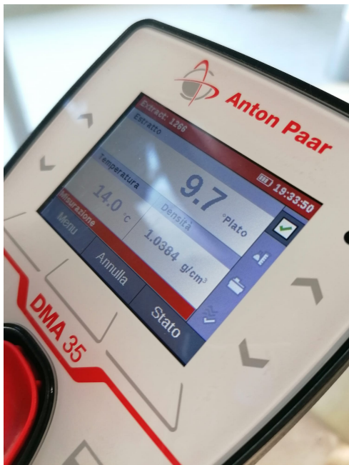
Figura 9 e 10. Anton Paar per rilevazione in tempo reale di estratto, temperatura e densità.
