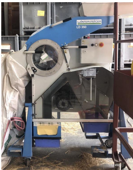
Figura 9: Trebbiatrice statica utilizzata per la trebbiatura delle parcelle
