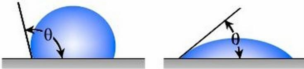
Figura 2.6 - Misura dell'angolo di contatto per una superficie idrofobica e una idrofilica.
