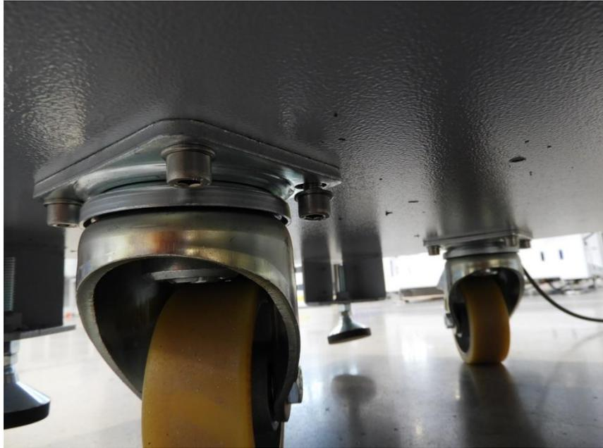
*FIG. 3.10 – Non conformità interna: mancato fissaggio di una vite.*
