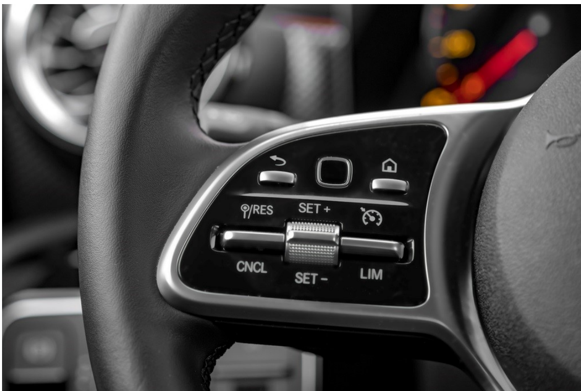
Figura 1.1: serie di comandi a volante per attivare, disabilitare e modificare il regolatore di velocità
