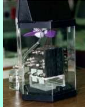
Fig.7. Stack di 12 celle di una DMFC
