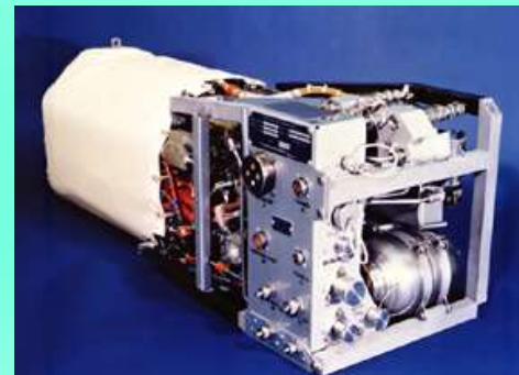
Fig. 4. Cella AFC usata nello Space Shuttle (NASA)
