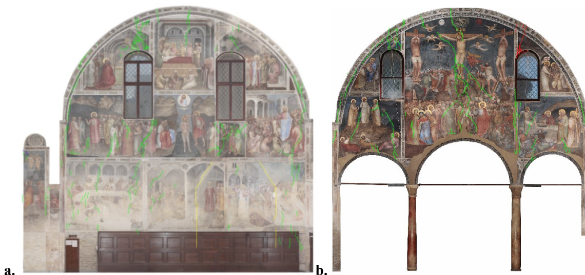
Figura 3.17 a. Quadro fessurativo interno prospetto sud Battistero; b. Quadro fessurativo interno prospetto est Battistero
