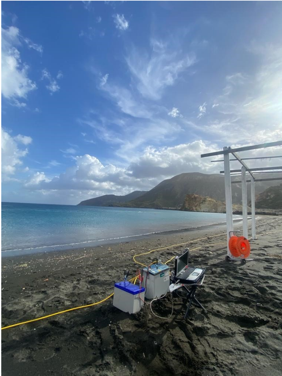
Fig 4.3 ERT acquisition near Baia di Levante.
