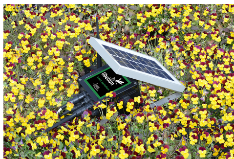
Sensore che monitora l'intensità della luce solare.
