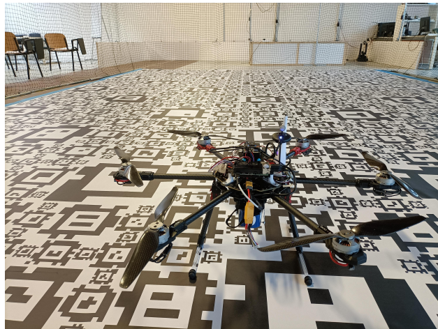
Figura 4: Arena di volo indoor , si noti la mappa di fiducial markers .
