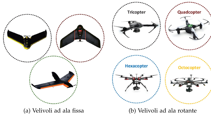
Figura 1: Classificazione aerodinamica di UAVs [1].
