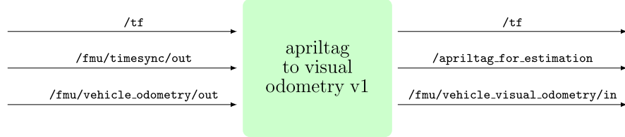
Figura 20: Topic in sottoscrizione (a sinistra) e in pubblicazione (a destra) per il nodo apriltag to visual odometry versione 1.
