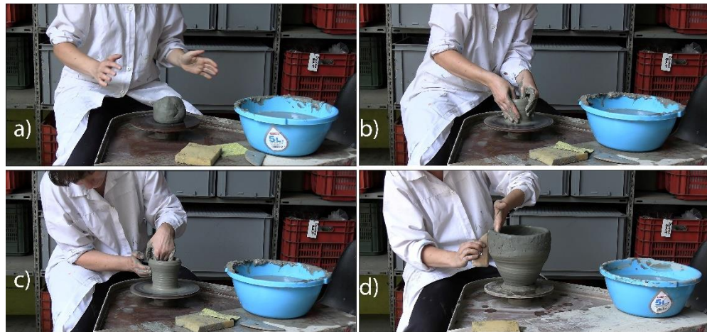
Fig. 22 Procedimento di creazione della Giara 2 (a) accentramento argilla; b) apertura dell'argilla; c) sollevamento pareti; d) rifinizione delle pareti con spatola di legno)
