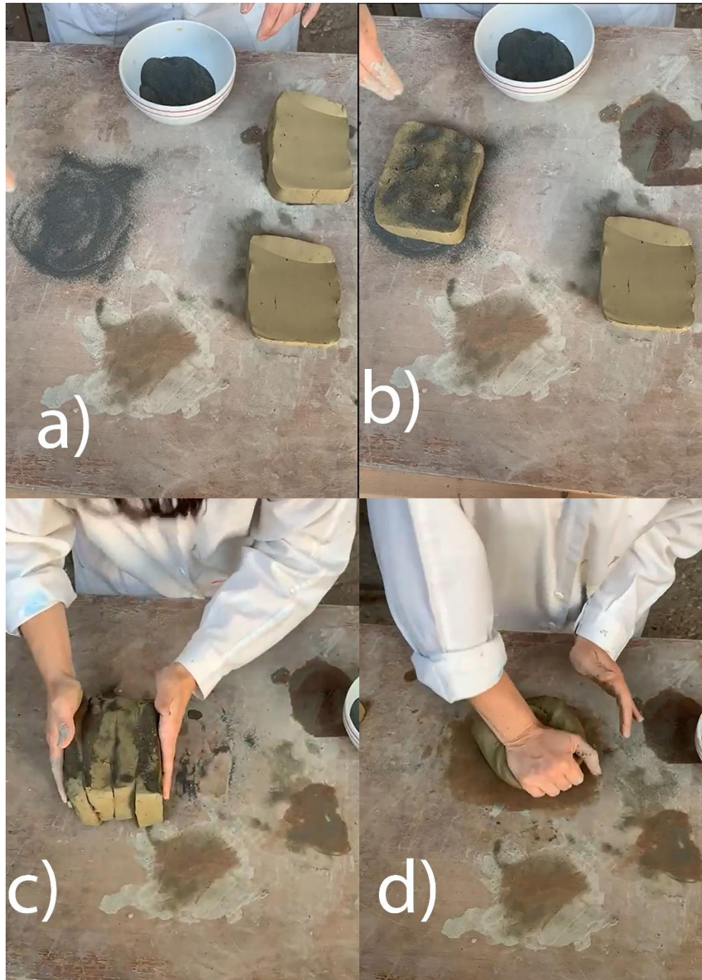
Fig. 35 Impastamento della sabbia basaltica (a) stesura della sabbia basaltica e dall'argilla; b) versamento della sabbia sull'argilla; c) modellazione dell'argilla; d) impastamento dell'argilla)
