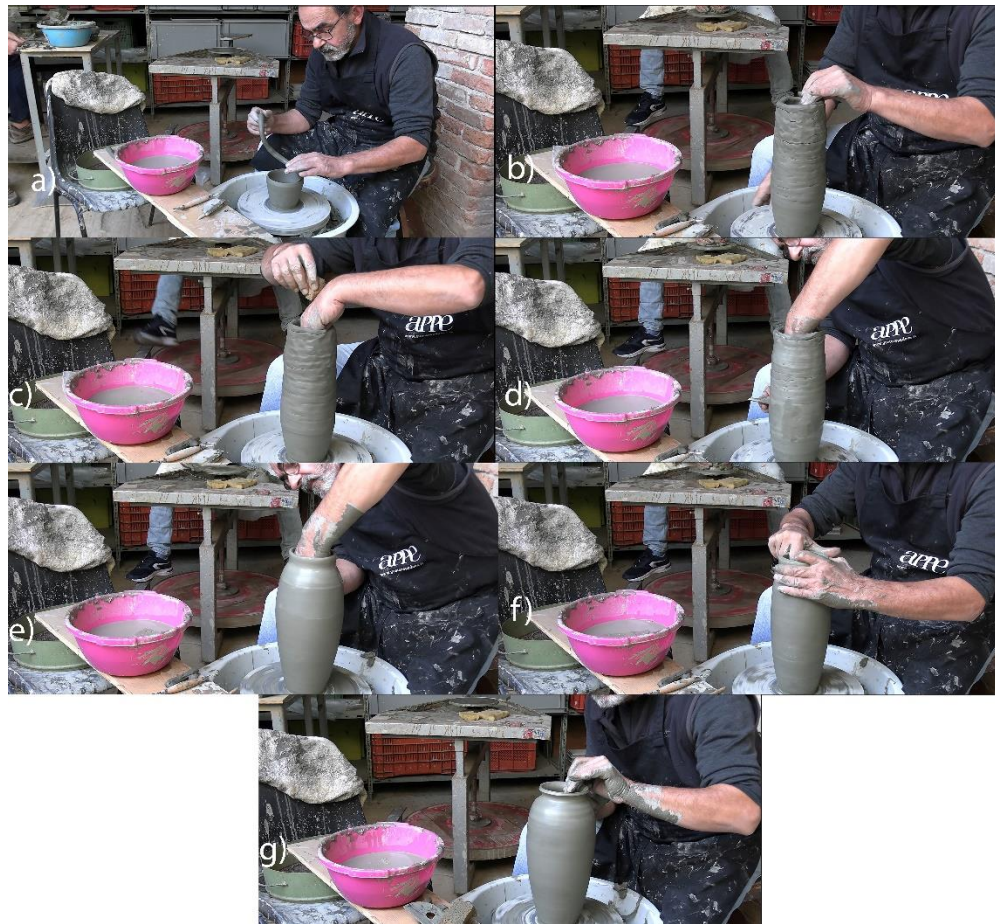
Fig. 42 Procedimento di creazione della Giara 7 (a) montaggio cercini sulla base; b) Forma cilindrica di 16 colombini; c) tornitura con una spugna; d) tornitura con una spatola di legno; e) allargamento delle pareti; tornitura dell'orlo; g) rifinizione dell'orlo)
