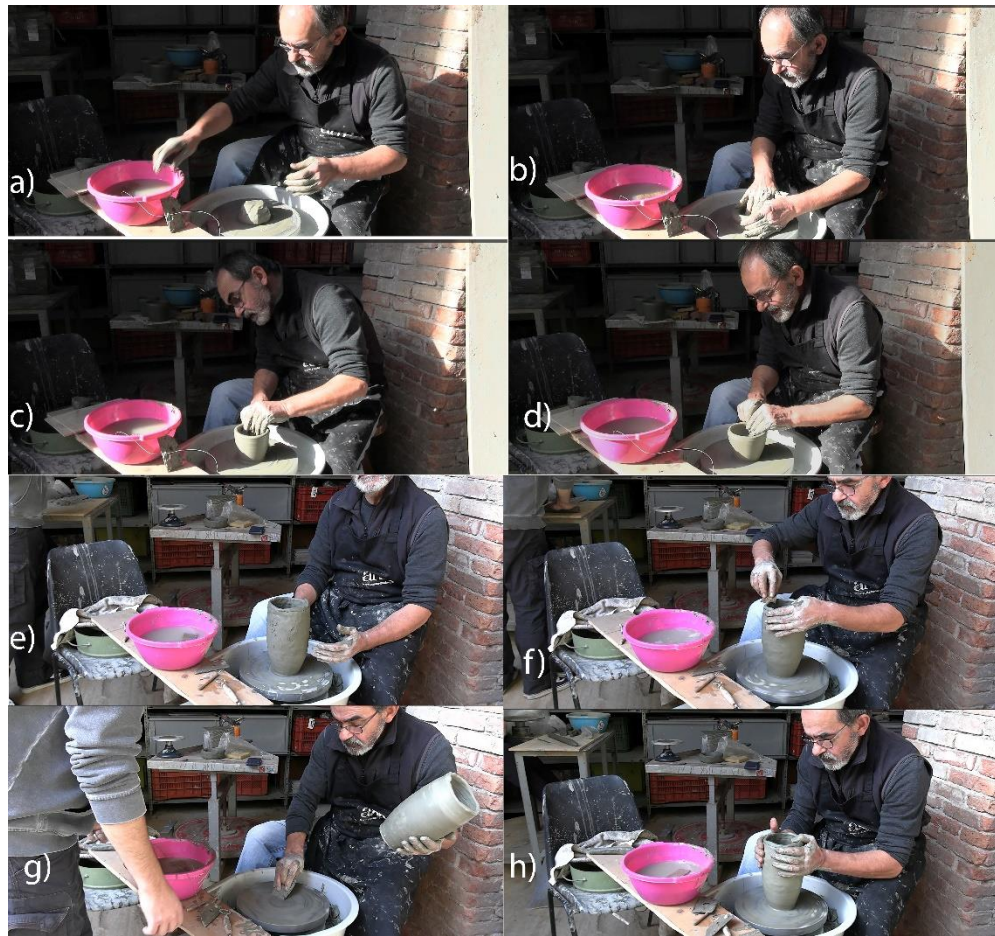
Fig. 40 procedimento di creazione della Giara 6 (a) centratura dell'argilla; b) apertura dell'argilla; c) sollevamento della base; d) rifinitura della base; e) forma cilindrica del vaso dopo montatura e saldatura dei colombini; f) tornitura e rifinitura dei colombini con una spugna; g) rimozione dell'argilla rimasta sul tornio per stabilizzare a Giara; h) ultima tornitura dei colombini prima dell'abbandono della Giara)
