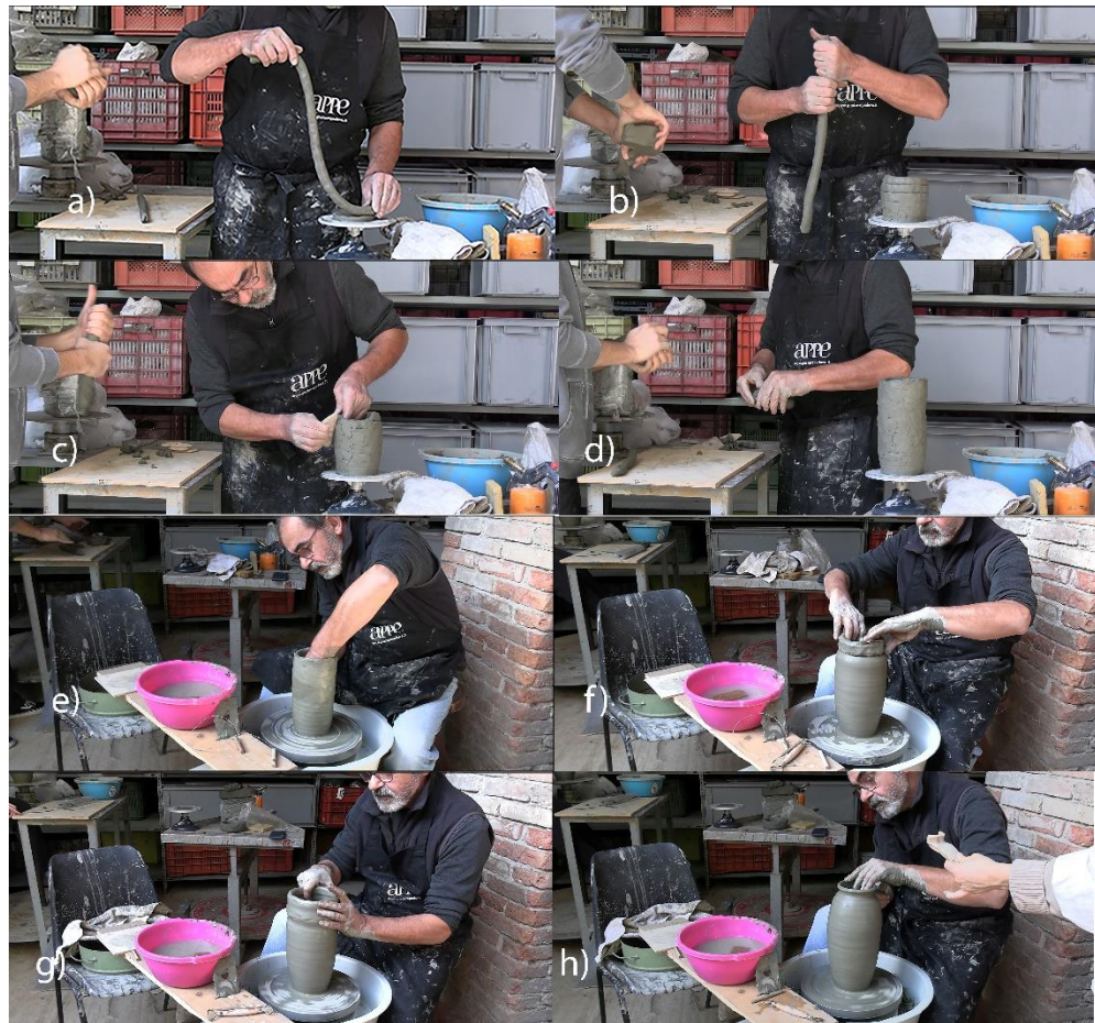
Fig.38 Procedimento di creazione della Giara 5 (a) montaggio del primo colombino; b) sistemazione dei colombini a mano; c) rifinitura e saldatura dei colombini con una spatola di legno; d) creazione della forma cilindrica del vaso; e) tornitura dei colombini; f) montaggio colombino per l'orlo; g) tornitura dell'orlo; h) rifinitura della Giara 5 e dell'orlo)
