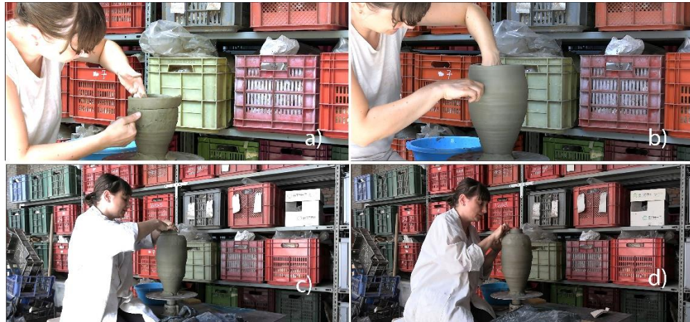
Fig. 24 Procedimento di creazione della Giara 3 (a) montaggio dei primi sei colombini; b) tornitura dei colombini; c) montaggio degli ultimi 3 colombini; d) rifinitura dell'orlo mediante il dito)
