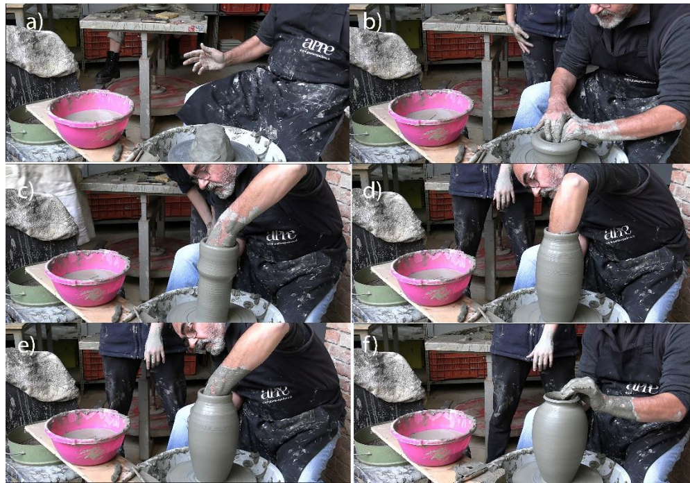
Fig. 44 Procedimento di creazione della Giara 8 (a) Centramento dell'argilla sul tornio; b) apertura dell'argilla; c) sollevamento pareti; d) allargamento pareti; e) tornitura dei colombini finale; f) rifinizione Giara 8 e orlo)
