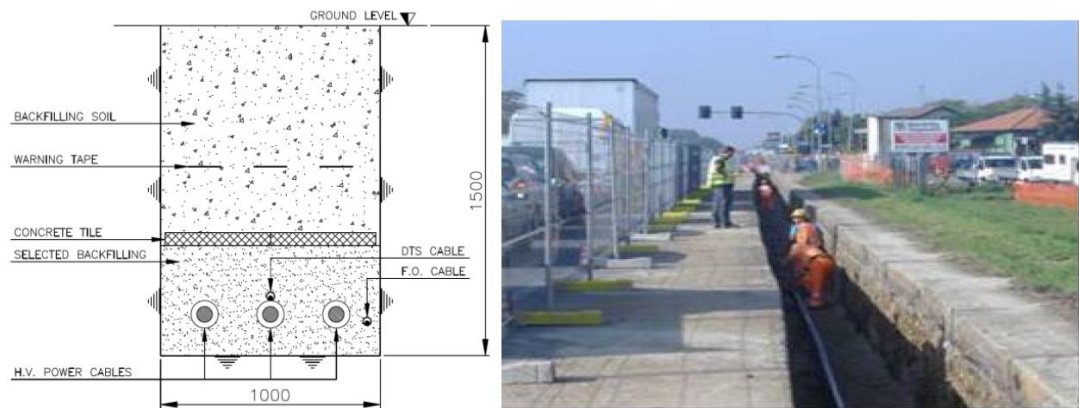
Figura 26 - Terna XLPE direttamente interrata con quote
