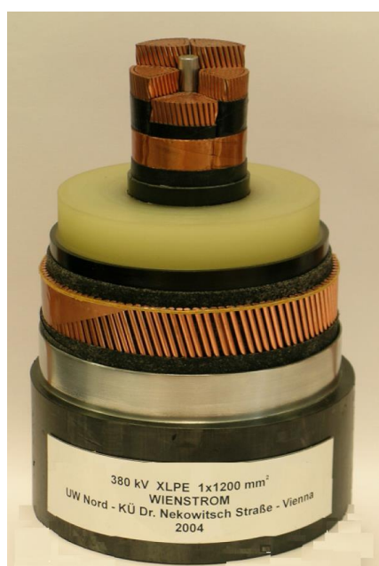
Figura 7 - Sezione di un cavo installato nell'impianto Wienstrom
