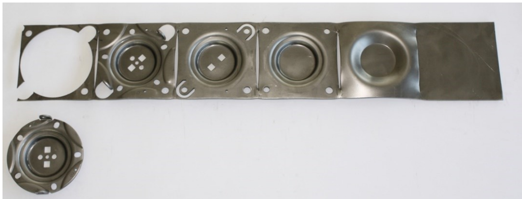
Esempio di componente realizzato con stampaggio progressivo
