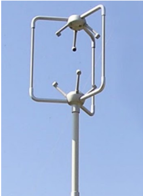
Figura 12, anemometro sonico (Istituto di Scienze dell'Atmosfera e del Clima)
