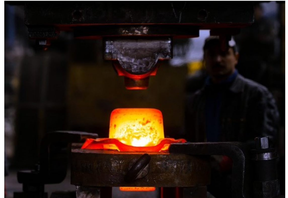
Esempio di processo per Forgiatura a caldo
