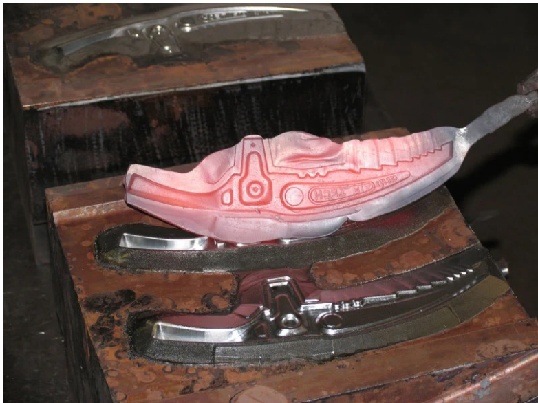
Esempio di semilavorato da Forgiatura a caldo
