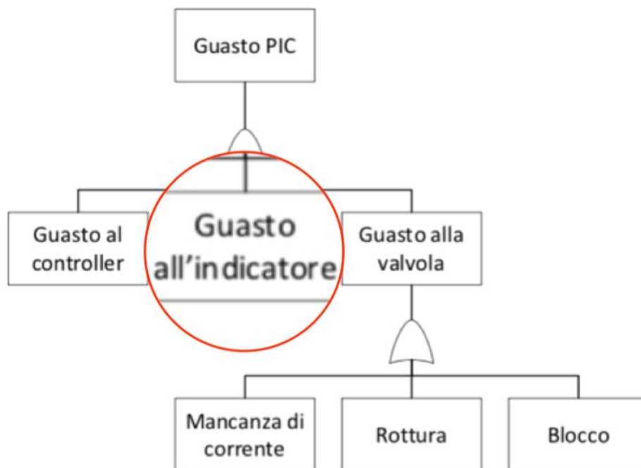
Figura 3.3.3.2 – MCS guasto pic con evento incidentale in evidenza
