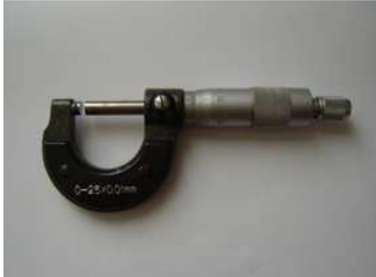
**Figura 2.12:** Micrometro con precisione al centesimo di millimetro utilizzato per la determinazione dello spessore delle foglie.
