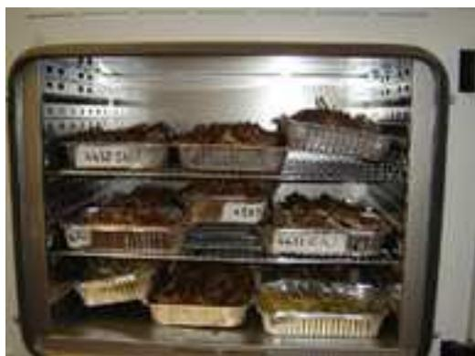
**Figura 2.10:** Foto illustrante le operazioni di essiccamento in stufa della componente erbacea e della lettiera del combustibile al fine di ottenere le rispettive masse di sostanza secca.
