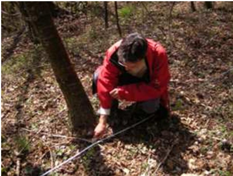
**Figura 2.6:** Foto illustrante la fase di rilievo del materiale legnoso morto al suolo: si può notare la cordella metrica stesa al suolo individuante il transetto lungo il quale avviene il conteggio dei singoli pezzi suddivisi, in base al loro diametro, nelle quattro classi di time-lag grazie all'utilizzo del calibro.
