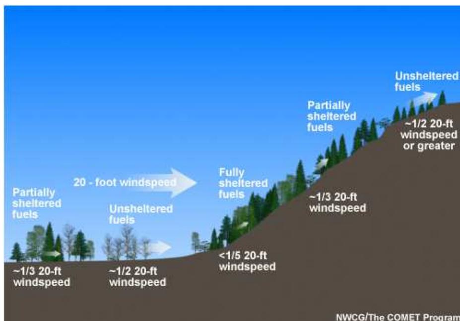
**Figura 2.14:** Riduzione della velocità del vento a livello dei combustibili di superficie a seconda della compattezza della copertura arborea (Tratta da Rothermel, 1983, modificata).
