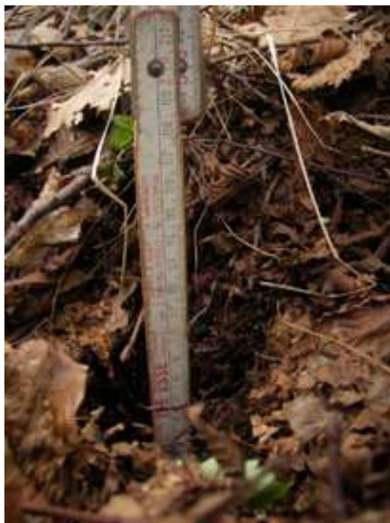
**Figura 2.8:** Foto illustrante la fase di rilievo della profondità dello strato di *duff* e della lettiera.
