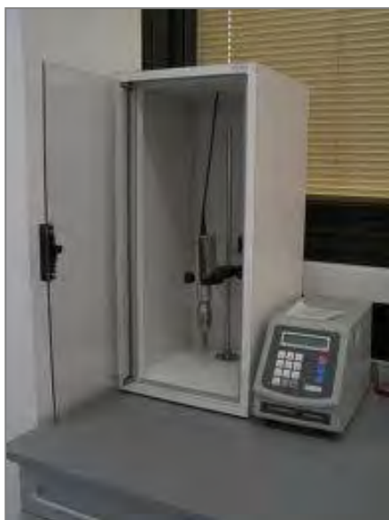
Figura 2.9. VC505 ® prodotto dalla Sonics Vibra-Cell
