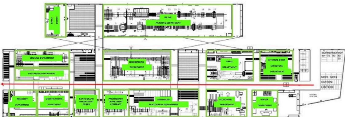
Figure 3.3 - Layout plant 1 di Barausse s.r.l (Barausse Srl, 2024)
