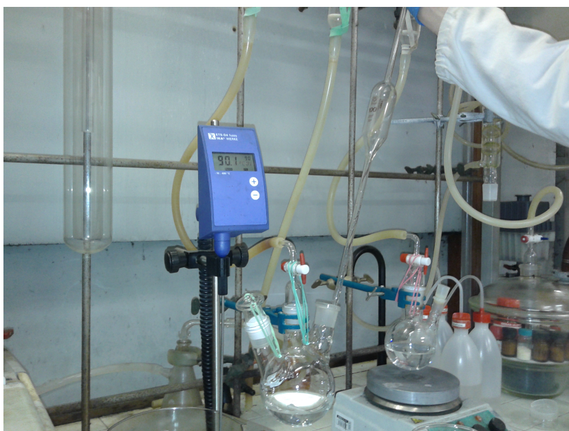
Fig. 5.1: La soluzione di ammonio idrossido viene aggiunta lentamente nel pallone.
