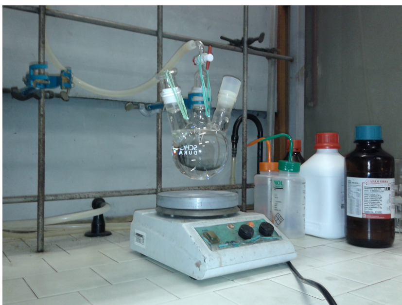
Fig. 5.2: Agitazione meccanica del contenuto del pallone.
