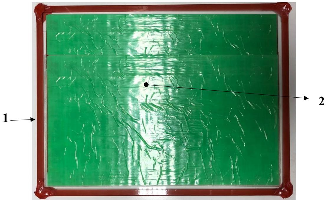
Figura 4.4: Risultato dopo la disposizione manuale del lay-up; si notano: 1) stampo, rivestito con nastro adesivo termoresistente; 2) laminato, con film polimerico protettivo non ancora rimosso.
