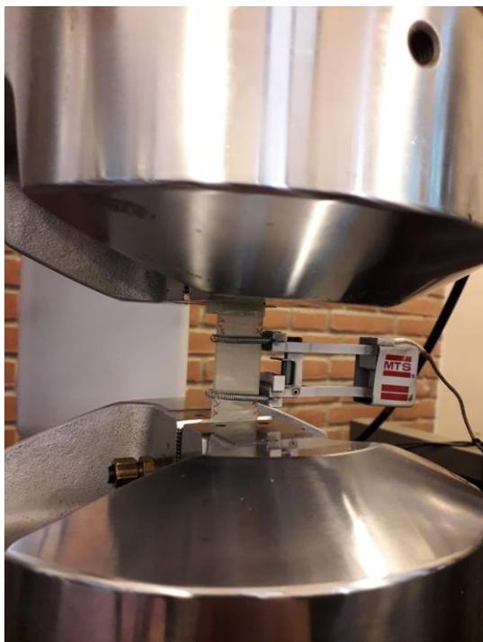
Figura 5.12 : Provino con estensometro montato.
