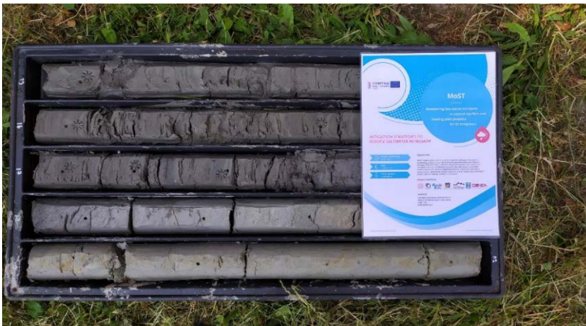
Fig. 2.11: Esempio di carota sedimentaria estratta da una perforazione.
