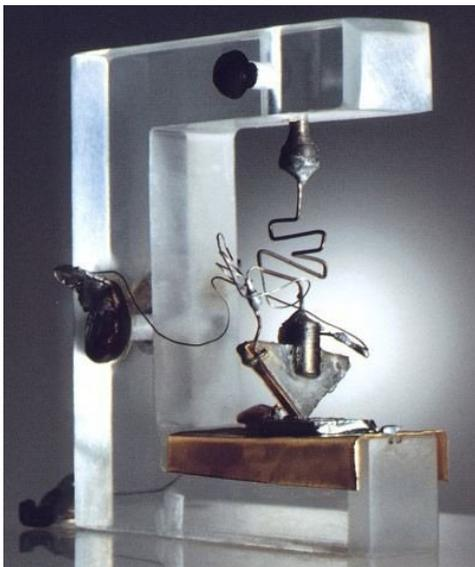
Figura 4.2: Il transistor a contatto puntiforme
