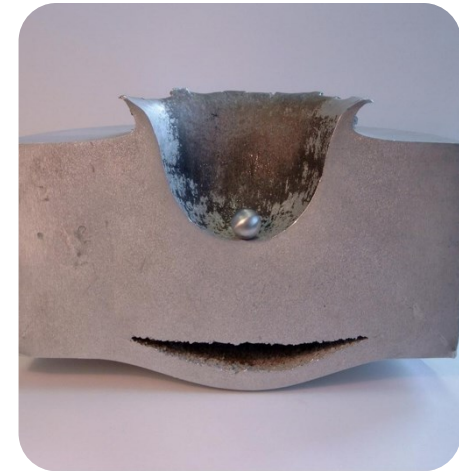
Impatto a 10 km/s su blocco di alluminio
