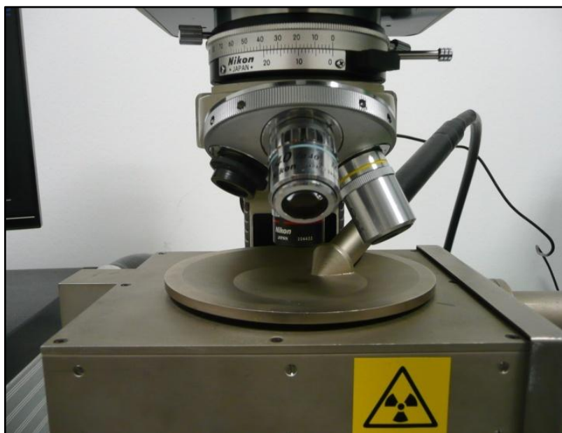
Fig. 4: Il microscopio da catodoluminescenza usato per le osservazioni; in evidenza, sotto gli oculari, la camera a vuoto.
