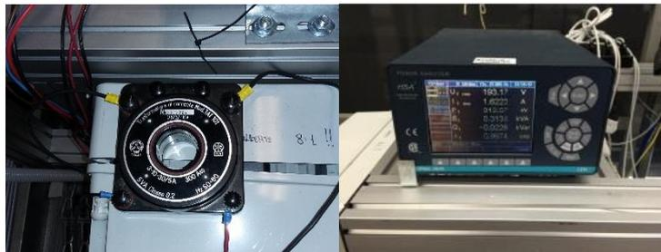
Figura 3.14 – Trasformatore TA e Fluke Norma 4000
