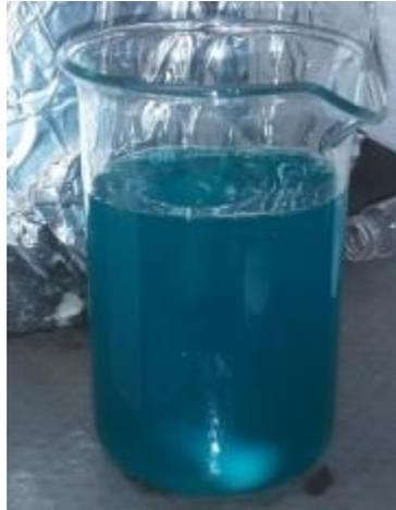
**Figura 4.9** – Soluzione di cloruro rameico per trattare il campione
