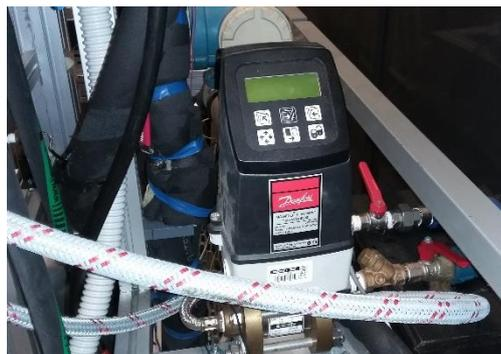
**Figura 3.13** – Misuratore di portata magnetico
