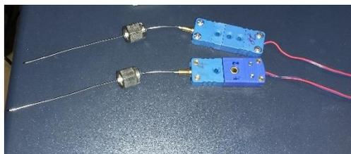
*Figura 3.15 – Termocoppie all'interno del campione per la misura della temperatura lungo lo spessore*
