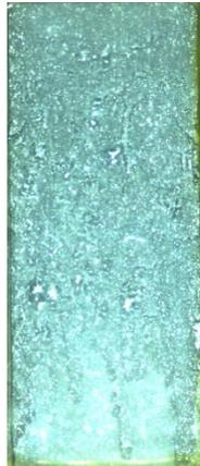
*Figura 5.31 – Immagine della condensazione sul Campione 3, la condensazione è a film*
