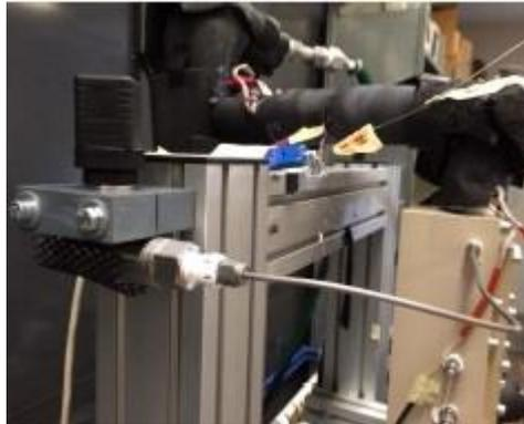
*Figura 3.11 – Misuratore di pressione differenziale.*
