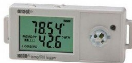
Figura 6. immagine esplicativa dei sensori Onset HOBO utilizzati durante la sperimentazione.
