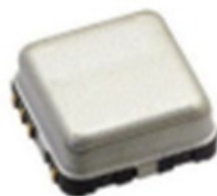
Figura 2.8: Sensore giroscopico EWTS64G [28]
