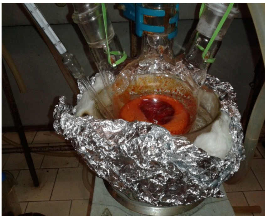
Figura 9: pallone a 3colli usato per la sintesi delle NPs in laboratorio
