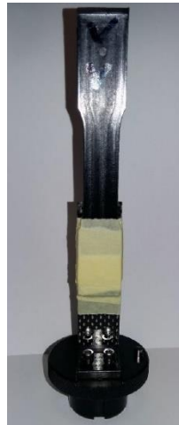
Figura 5.1. Faccia frontale del provino, preparazione per la scansione al tomografo
