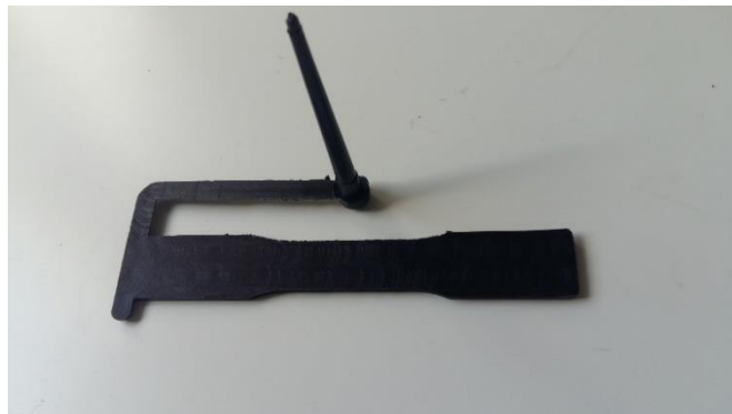
Figura 6.6. Provino ottenuto tramite stampaggio ad iniezione. Sono presenti anche lo sprue e il runner
