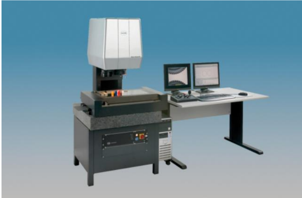
Figura 6.22. Macchina di misura a coordinate a collo di cigno, a sensore multiplo, da tavolo. Werth VIDEOCHECK® S
