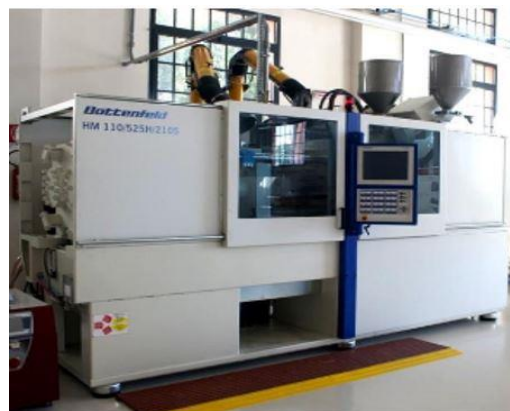
Figura 6.5. Pressa di stampaggio ad iniezione Battenfeld® HM 110/525H/210S
