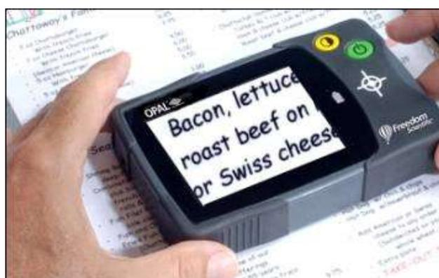
Figura 8 – Esempio di videoingranditore portatile. Fonte: [www.superabile.it](http://www.superabile.it).
