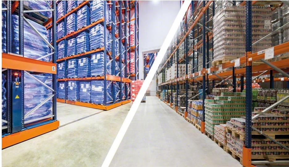
Figura 2.8: Esempio di scaffalature compattabili e scaffalature portapallet
