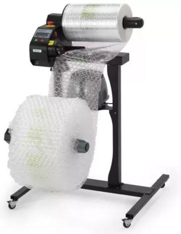
Figura 2.21: Macchina per riempitivi ad aria
