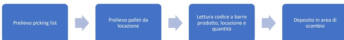
Figura 4.6: Macro-attività del processo di picking a svuotamento
