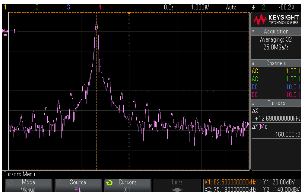
Figura 47: Verifica della frequenza di modulazione PWM.
