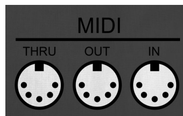
Figura 50: Porte per la comunicazione con protocollo MIDI.
