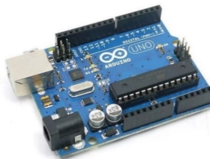
Figura 36: Scheda Arduino UNO.
