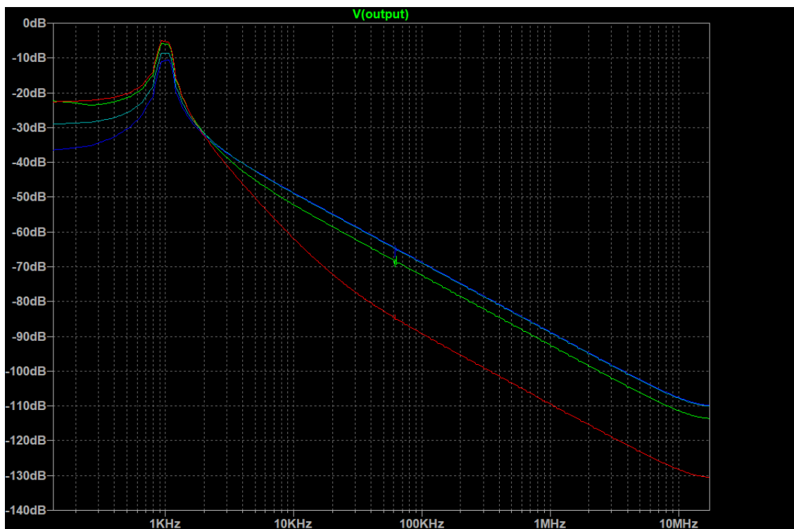
Figura 34:FFT eseguita sul segnale in uscita all'intero circuito, simulato con LTSPICE.
