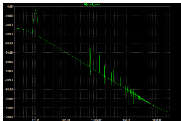
Figura 20: FFT del segnale in uscita dal filtro controllato in PWM, ottenuta con LTSPICE.
