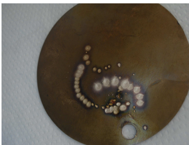
Figura 3.32: Foto del target al termine delle prove di ablazione con polarizzazione
