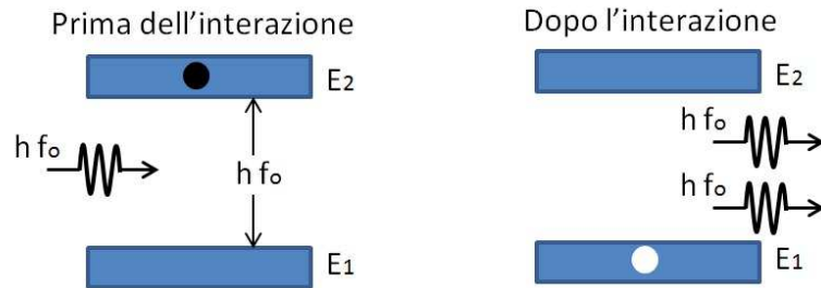
Figura 2.1: Emissione Stimolata in un sistema a 2 livelli di energia
