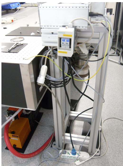
Figura 3.6: Pompe da vuoto primaria di colore arancione e pompa secondaria a diffusione posizionata sotto alla camera da vuoto
