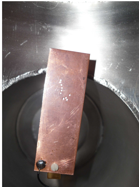
Figura 3.20: Target dopo le prove di focalizzazione del fascio laser
