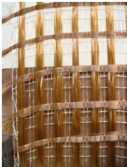
Figura 2-5: tessuto di fibre di PBO (poli-parafenilene benzobisoxazolo)
