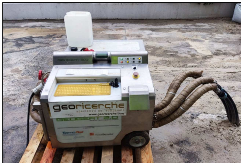
Figura 10. GEOgert 2.0 Modulo 1 e Modulo 2, GRT in fase di esecuzione del test.
