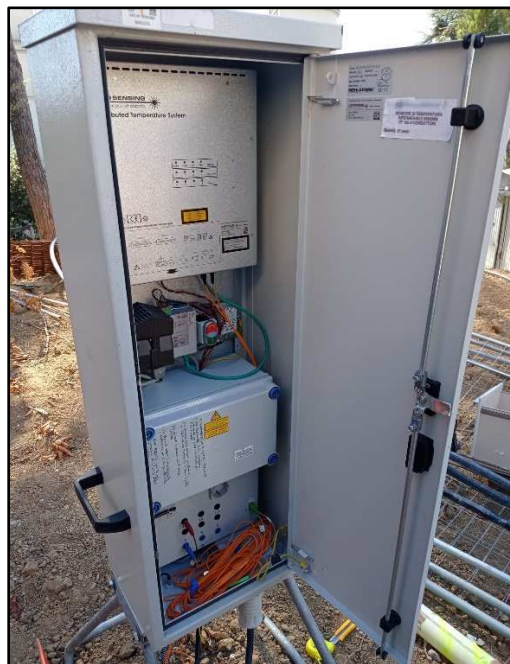
Figura 30. Interrogatore, sistema riscaldante e CPU del dispositivo "GeoDTS".
