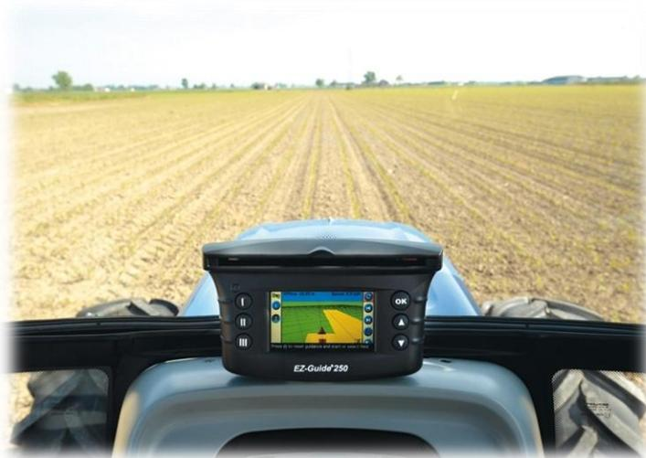
Figura 3.1: Display del sistema barra di guida
