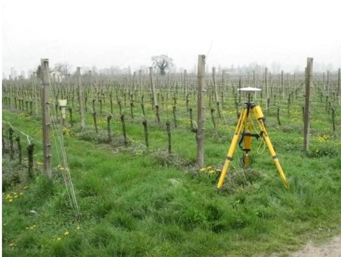
Figura 4.8: Stazione base RTK utilizzata nelle prove su punto fiduciale aziendale
