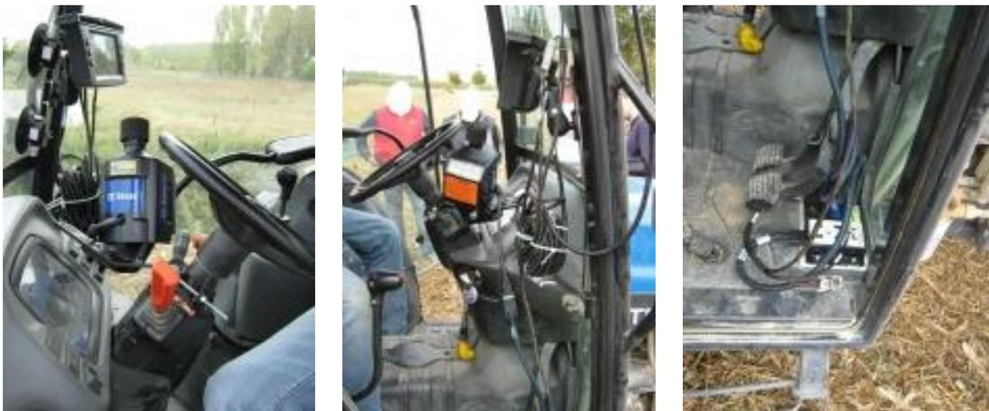
Figura 4.7: Esempio di sistema EZ-Steer montato su trattore
