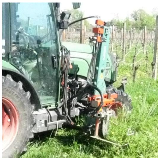
Figura 4.3: Lama intercetto utilizzata nelle prove
