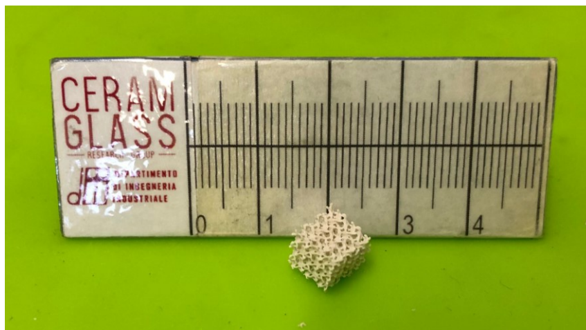
Figura 51 Scaffold in sfene con struttura GM-90 dopo trattamento termico.
