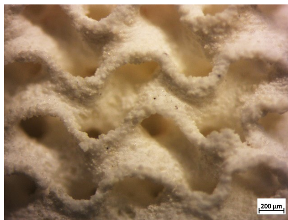
Figura 74 Ingrandimento di uno scaffold ottenuto da polimeri preceramici e sottoposti a trattamento termico.
