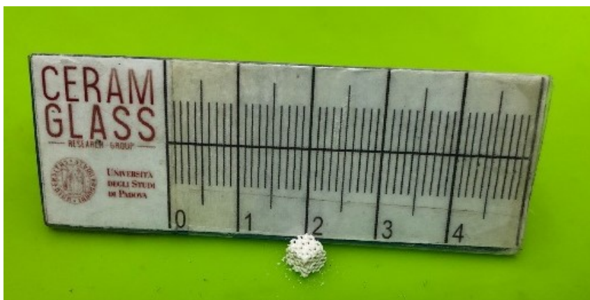
Figura 71 Scaffold di sfene ottenuto mediante inchiostro C e sottoposto a trattamento termico a 1200°C.
