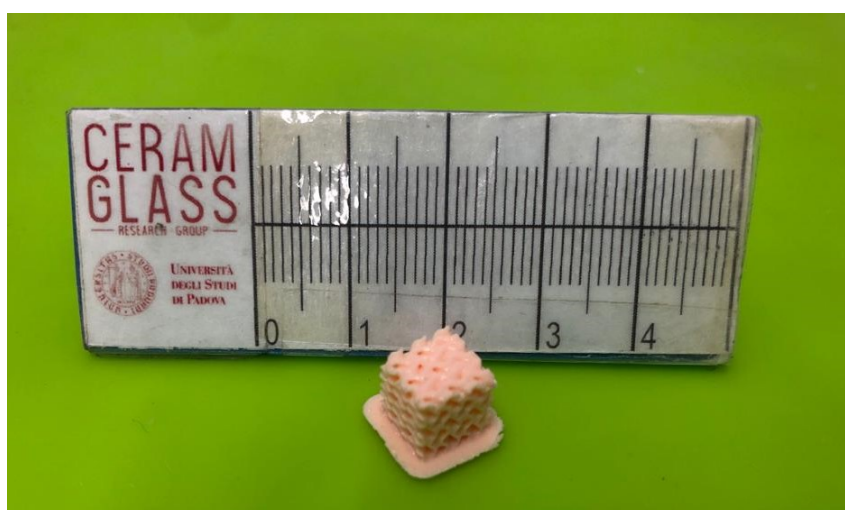
Figura 63 Scaffold di sfene ottenuto mediante inchiostro A e stampati con resina arancione.
