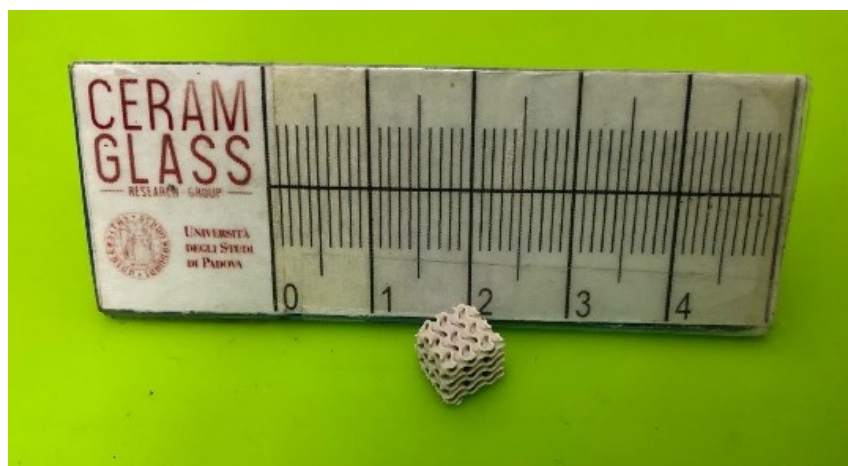
Figura 43 Scaffold in sfene dopo trattamento termico a 1200°C con struttura GZ-85.
