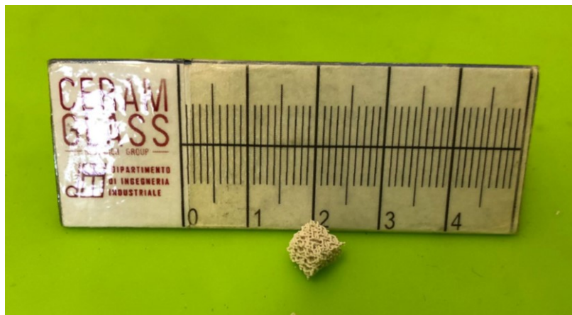
Figura 56 Scaffold in sfene con struttura GA-90 trattato termicamente.
