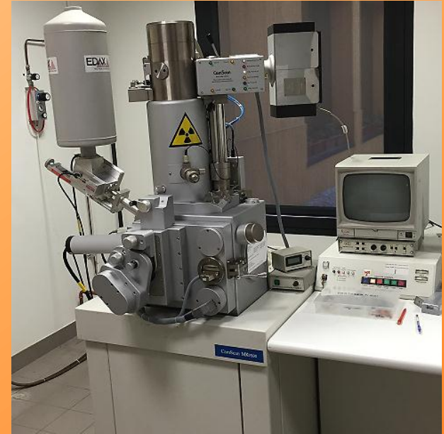
CamScan MX3000 con sorgente \text{LaB}_6 (Dipartimento di Geoscienze, Padova).
