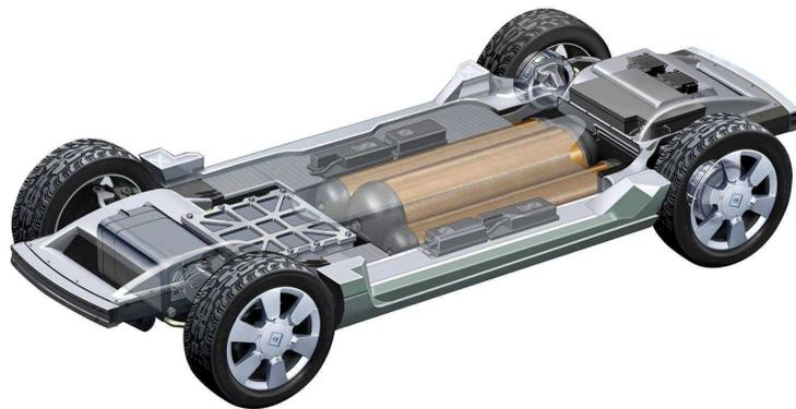
*Figura 52. Telaio modulare della GM Sequel*
