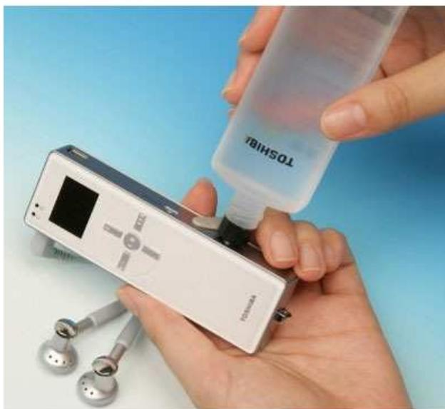
**Figura 26.** Lettore Mp3 Toshiba con DM-FC
