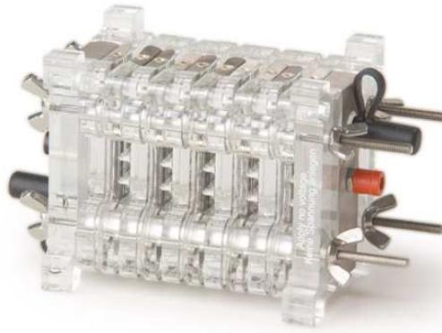
*Figura 31. Stack di celle a combustibile*
