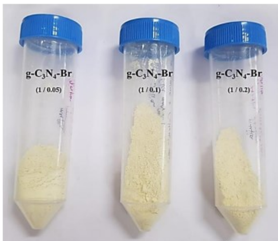
Composti di nitrato di carbonio grafatico drogati rispettivamente con 0.05/0.1/0.2 g di HBr. g-C 3 N 4 -Br-1
