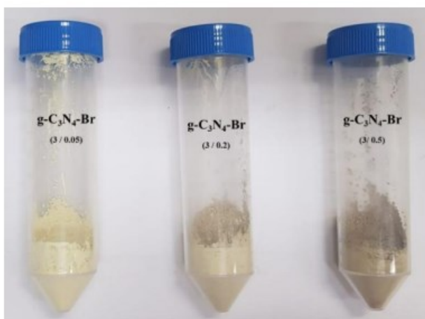
Composti di nitrato di carbonio grafatico drogati rispettivamente con 0.05/0.1/0.2 g di B r C 6 H 4 N(CH 3 ) 2 . g-C 3 N 4 -Br-3
