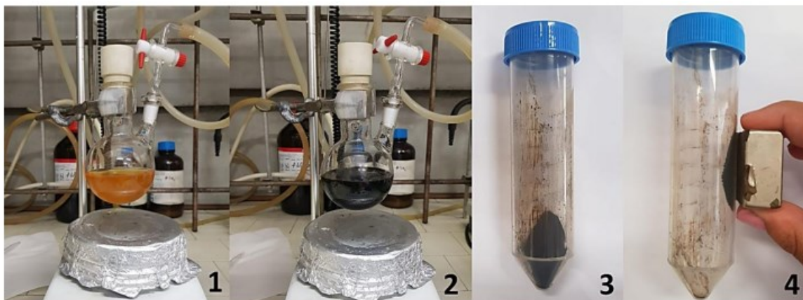
Figura 4.3.4 : 1- soluzione dopo aver disciolto i reagenti in acqua; 2- soluzione dopo l'aggiunta di \text{NH}_4\text{OH} ; 3- polvere MNPs (nanoparticelle magnetiche); 4- proprietà magnetiche delle nanoparticelle
