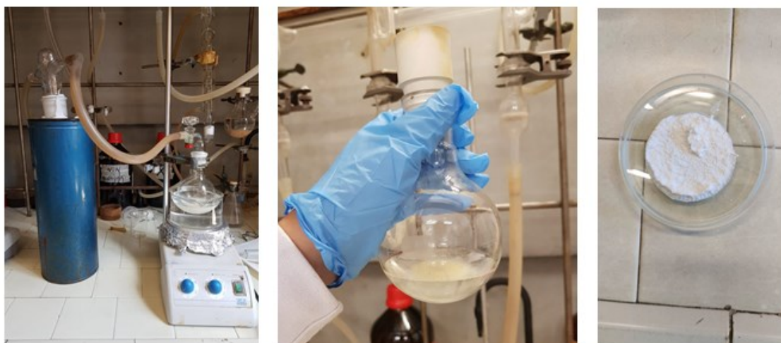
Figura 4.3.2 a: In sequenza da sinistra verso destra, processo evaporativo, soluzione di melamina e filtro ad evaporazione avvenuta
