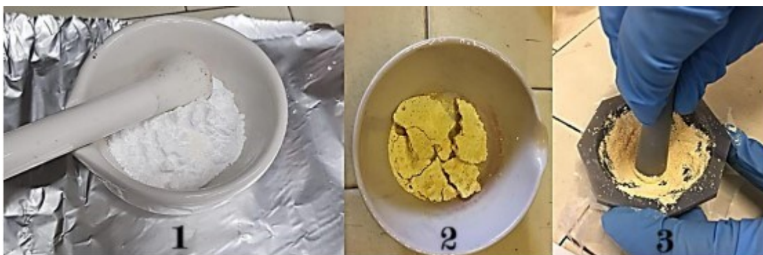
Figura 4.3.1: 1-Melammina nel mortaio; 2- g-C_3N_4 dopo muffola; 3- g-C_3N_4 polverizzato in mortaio 27
