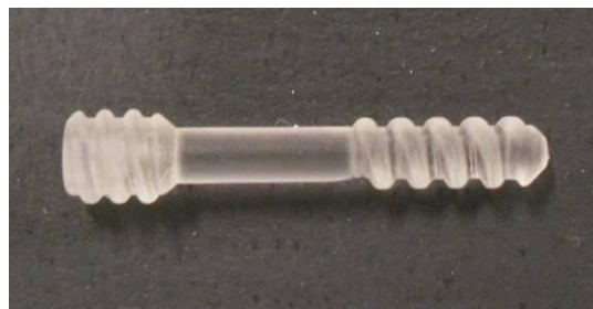
Figura 3.2: vite riassorbibile a doppia filettatura (RSB 460-22).
