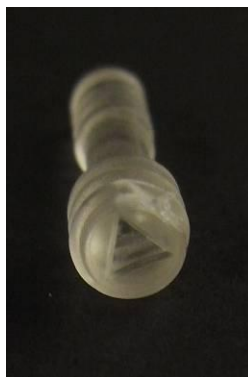
Figura 5.2: particolare della cava triangolare della vite.
