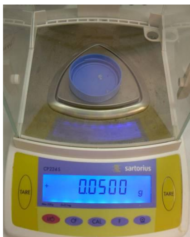
Figura 5.14: campione tagliato e pesato per la prova di viscosità.
