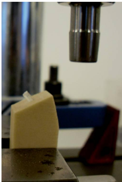
Figura 6.21: vite giunta a rottura in seguito all'applicazione del carico
