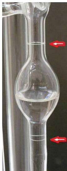
Figura 5.13: viscosimetro capillare: particolare del bulbo e delle tacche di riferimento.
