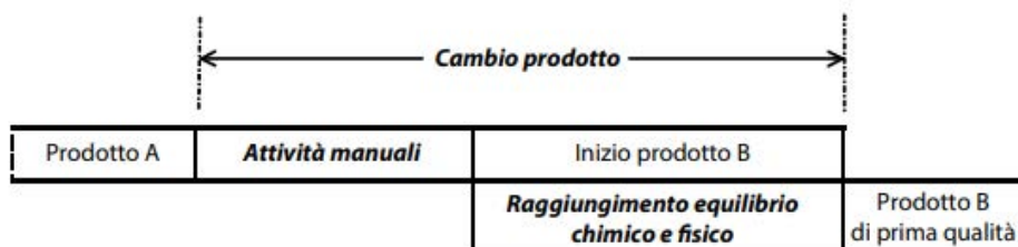
Figura 4.5 - Un cambio prodotto in cui hanno luogo sia processi chimico-fisici sia attività manuali (King 60 ,2009)
