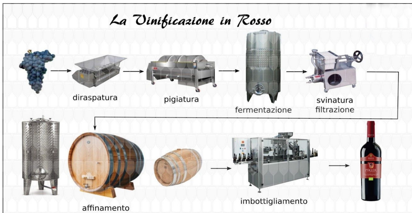
Figura 1.2 Schema di vinificazione in rosso (da www.quattrocalici.it )
