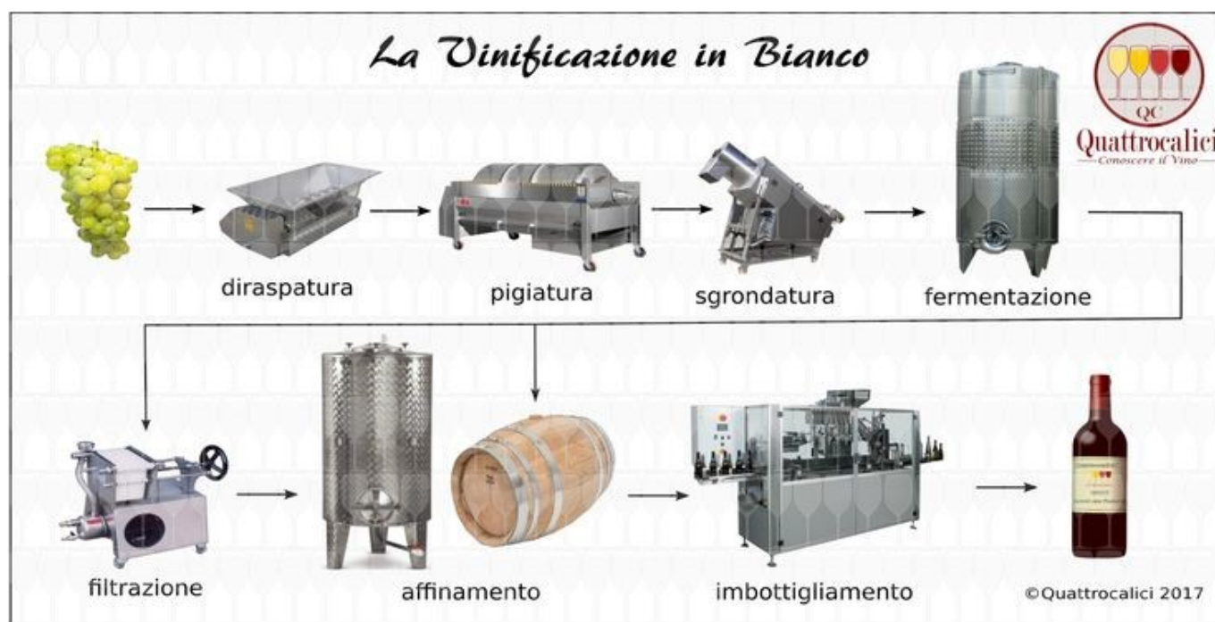
Figura 1.1 Schema di vinificazione in bianco (da www.quattrocalici.it )
