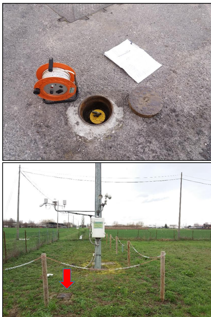
Figura 4.14: due esempi di pozzetti utilizzati per ricavare le misure di soggiacenza, nell'immagine superiore si vede anche il freaticometro usato.
