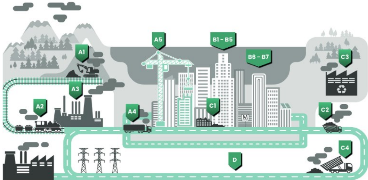
fig. 1.5 - Schematizzazione delle fasi del ciclo di vita di un edificio secondo normativa. Fonte: (One Click LCA, 2021)
