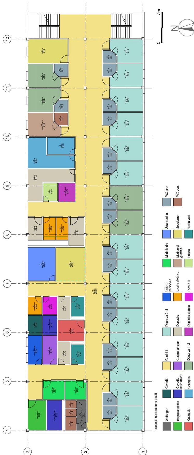
fig. 0.4- Planimetria del prototipo D - corpo triplo con camere "ridotte" da 18 m 2 . Fonte: disegno dell'autrice
