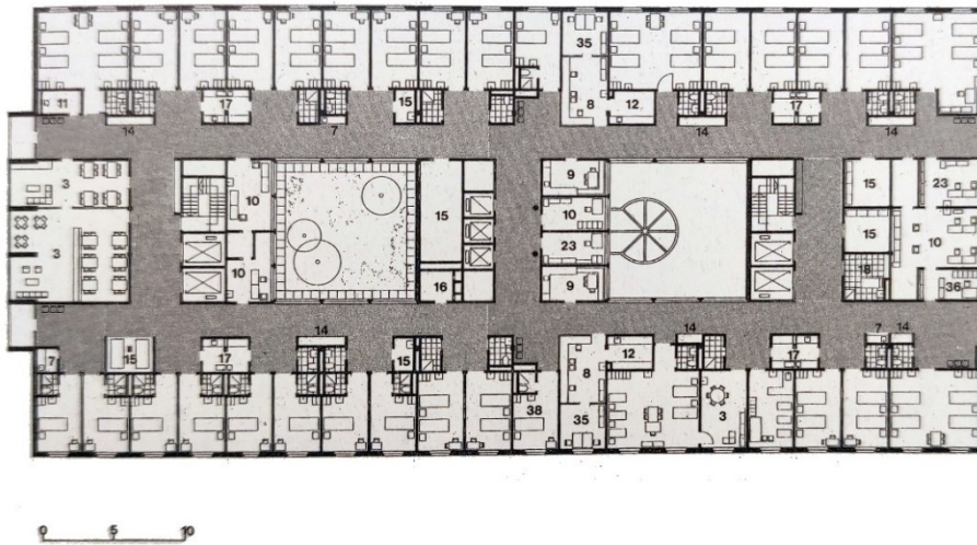
fig. 3.4 - Esempio di degenza a corpo quintuplo con corti interne. Ospedale universitario di Zurigo, Svizzera, 1985. Fonte: Rossi Prodi & Stocchetti, 1990
