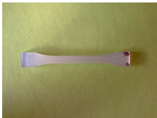
Fig. 4.5 - Esempio di provino per test a trazione di Pebax ® 40R53.
