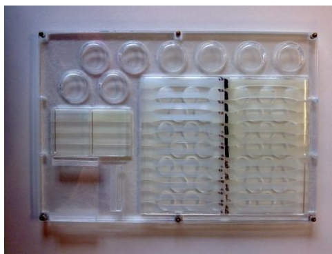
Fig. 4.8 – Griglia in PMMA dove i provini vengono inseriti durante il trattamento di umidità.
