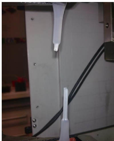
Fig. 4.9 - Provino sottoposto a trazione e portato a rottura.
