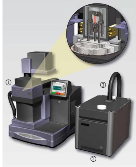
Fig. 3.5: DMA e accessori: 1-forno o camera di prova, 2-accessorio che contiene un umidificatore e dei componenti elettronici, che continuamente monitorano e controllano la temperatura e l'umidità della camera del campione, 3- linea di trasferimento riscaldata a vapore mantenuta ad una temperatura al di sopra del punto di condensazione del gas in modo da evitare la condensa e di fornire risultati accurati.
