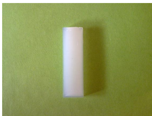
Fig. 4.6 - Esempio di provino per test DMA di Pebax ® 72R53.
