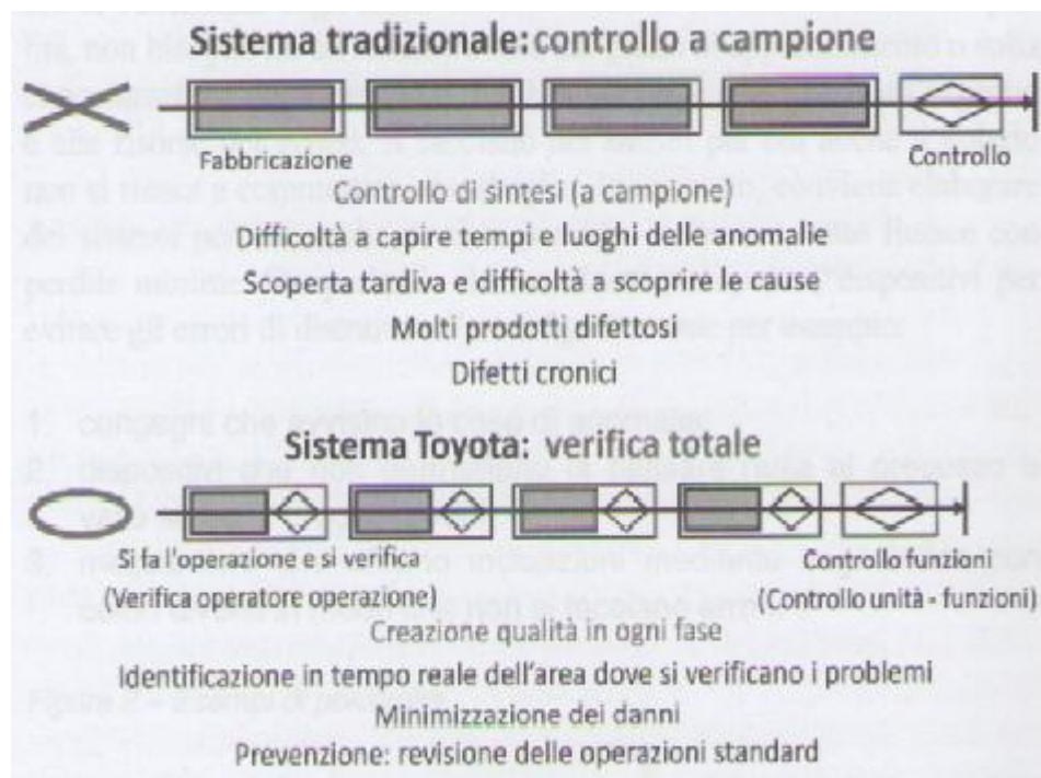
Figura 1.1. Due differenti modalità di controllo: un solo collaudo alla fine oppure piccoli step frapposti alle fasi di lavorazione.
