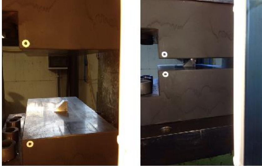
Figura 5.19 Esempio di posizionamento a centro stampi del provino in posizione ruotata di 180° attorno all'asse verticale rispetto alla precedente e deformazione del provino.
