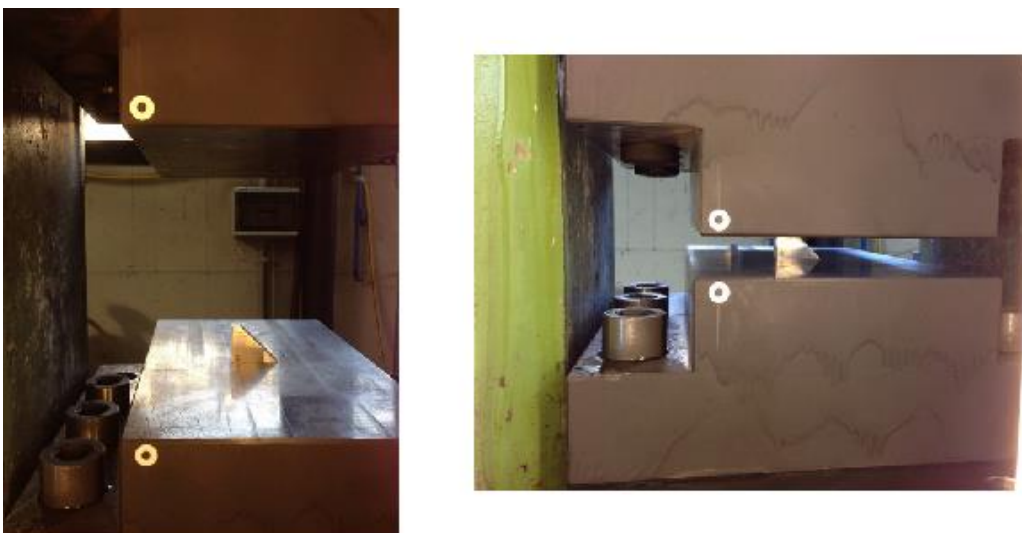
Figura 5.18 Esempio di posizionamento a centro stampi e deformazione del provino.
