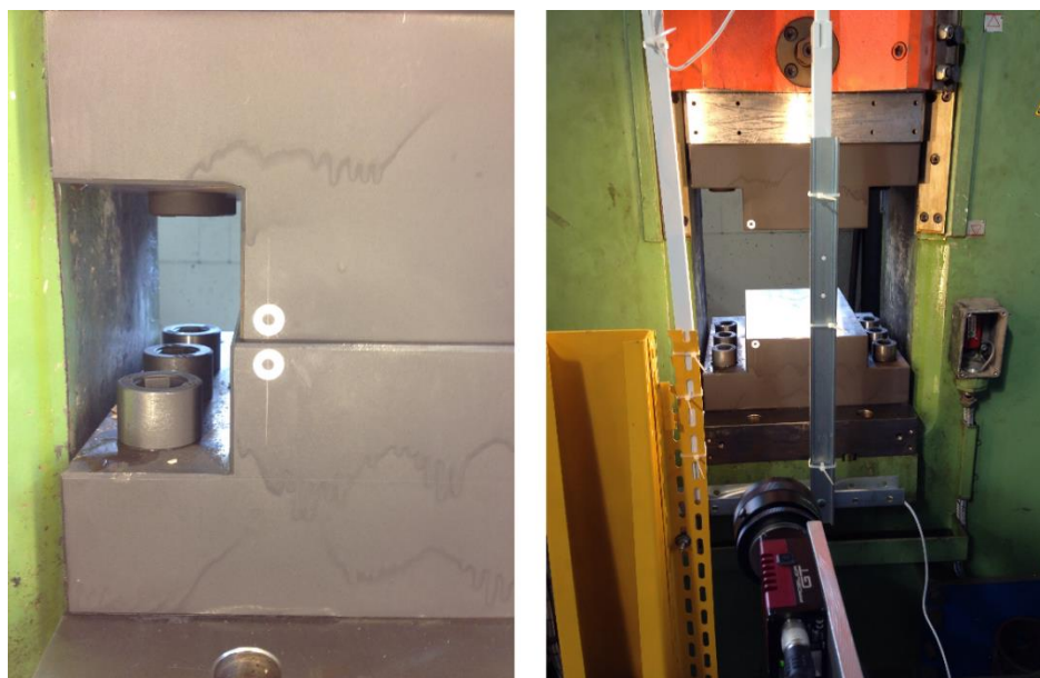
Figura 5.14 Set-up del sistema di visione per le prove sulla pressa a vite Vaccari.
