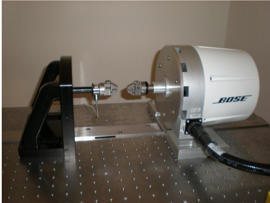
Figura 4.3 : Apparato sperimentale per prova monotensionale
